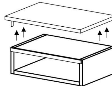
(3) Schrauben der Befestigungswinkel lösen. Anschließend beide Befestigungswinkel um 5mm nach außen verschieben und wieder befestigen
