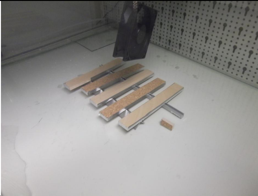
Abb. 1: Prüfstück in der 0,125 m 3 Prüfkammer
